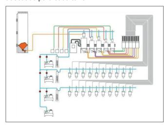
La capacidad y el rendimiento del secador central se ajusta al número de tolvas que sirve. Un sistema puede constar de más de un secador central, cada para servir a múltiples tolvas, con el sistema de materiales general ajustado a las necesidades totales de la instalación.
