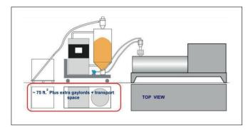
El equipo de secado y manejo en una máquina de procesamiento ocupa cerca de 7 m2 de espacio. El sistema de secado y transporte central puede emplear ese espacio para usos rentables.
